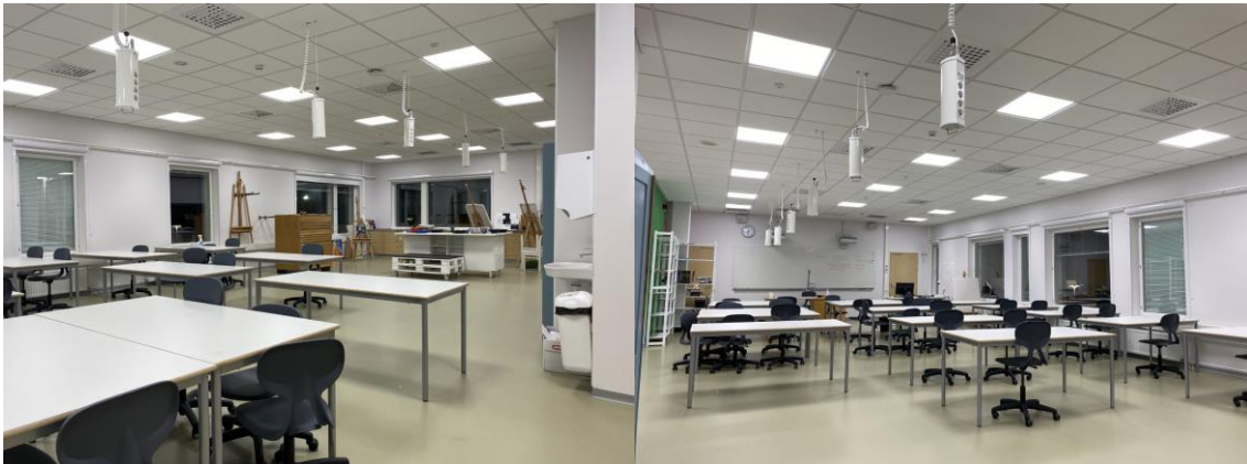
Kuva 18. Muhoksen lukion oppimistiloissa on sijoitettu sähköpisteitä kattoon. Tämä järjestely helpottaa myös siivousta. Runsaasti pöytätilaa esimerkiksi projektityöskentelylle saadaan yhdistämällä parityöskentelypöytiä. Pyörällisiä tuoleja on helppo siirtää ja niillä voidaan liikkua paikasta toiseen. (Lähde: Minna Kemppainen)
